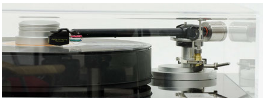
Quando la puntina raggiunge il solco più interno del disco, il contrappeso del braccio si avvicina alla parete laterale della cappa; per evitare il contatto è opportuno bilanciare i due contrappesi in modo da portare quello esterno il più lontano possibile dall'estremità.
