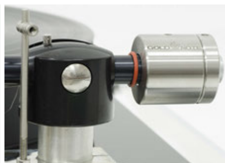
Quando la puntina raggiunge il solco più interno del disco, il contrappeso del braccio si avvicina alla parete laterale della cappa; per evitare il contatto è opportuno bilanciare i due contrappesi in modo da portare quello esterno il più lontano possibile dall'estremità.
